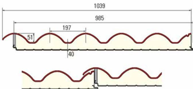
Pannello metallico di coperture a forma di coppo con isolamento poliuretano e supporto in lamiera in acciaio zincato preverniciato o plastificato, in acciaio inox, in alluminio naturale o preverniciato o lamiera semplice.
